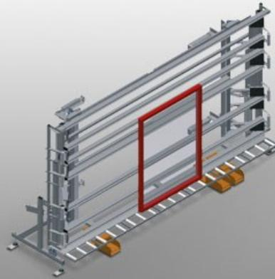
用于在单件和批量流水线上进行玻璃安装和最终检测的玻璃安装检测台
