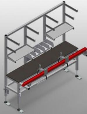
用于预装五金件和和密封件的组装工作台。钢制结构、坚固稳定。用于在门窗上预装五金件和密封件的工作台。配别两个夹具。用于结构深度 45 – 120 mm 和可见宽度 50 – 150 mm 的型材的夹具。夹紧位置可设置。通过脚踏开关激活夹紧缸。摆动装置可摆动 180°、通过脚踏开关可
