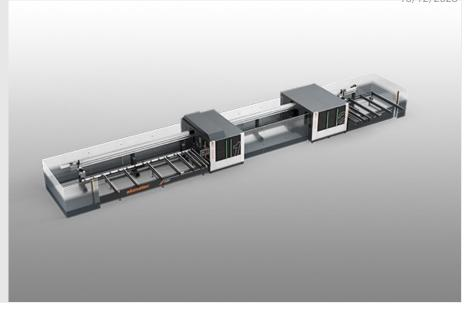
这款先进的自动铝材加工中心 SBZ 625/13 为用户提供了无与伦比的精度和灵活性。该加工中心配备多达 40 个轴,坚固耐用,功能强大。 无论是铝材标准型材还是门窗型材的加工,都能够轻松实现。并行的加工步骤大大缩短了生产时间,直观的操作界面确保了操作的简便 性。
