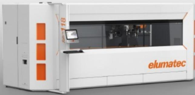
SBZ 118是一款三轴型材加工中心，可选择五面加工，使用方便，占地面积最小，扩大了它扩大了elumatec的入门级产品范围，用于铝、PVC和薄壁钢型材的自动化数控加工。它的加工长度为这款多功能、功能强大的机型是目前elumatec系列中最紧凑的数控机床。
