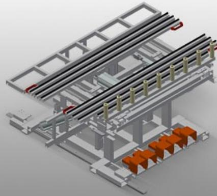
钢制结构、坚固稳定。带回缩装置的组装翻转工作台。基本尺寸 1.400 x 2.000 mm、拉出时尺寸 2.000 x 2.800 mm。该工作平台由两个可拉出的带刷条的支承横梁组成。工作平台最小尺寸 2.000 x 1.000 mm。工作平台最大尺寸 2.800 x 2.000 mm。两个支承横梁形成一个框架、框架通过气动方式可在 1.000 - 2.000 mm 的高度上无级移动。带脚踏阀门的升降和倾斜装置。滚道固定安装、带 100 mm 升降装置。用于与滚道之间进行移交/接收的升降装置。滚道前部敞开、用于缩回移交滚道。行走装置带凸缘滚轮和气动驻车制动器以及侧面操控装置。 选件：用于 RMT 1400 的工作台支承面毛毡滑条；带手动阀的辅助夹具。
