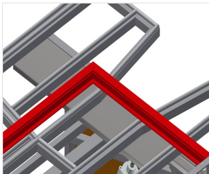
支承面 带塑料滑条的工作台支承面
