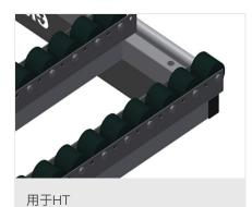
2045/PVC的整套滚轮支架 带有聚酰胺涂层的塑料滚轮,滑动轴承,每滚轮的承 载能力为: 60 kg,是输送和搬运PVC元件的理想之选
