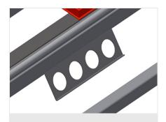
工具架 用于气动和电动工具的工具架
