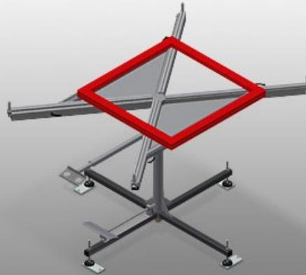
用于在框架和窗扇上进行加工作业的旋转工作台。钢制结构、坚固稳定。可旋转工作台。工作台可广泛应用于各种装配工作：可作为安装密封件的工作台、用于在特殊加工系统中的后续补充加工、五金件安装以及最终安装。四个可无级抽拉的支撑悬臂。支撑悬臂带橡胶型材覆层。工作台可旋转 360°并且通过踏板制动。带有实用的供摆放工具或其它物件的托盘以及工具架。
