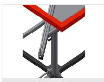
支承面 支撑悬臂带橡胶型材覆层
