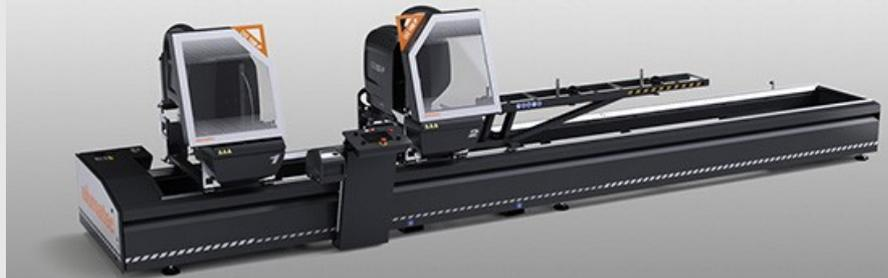
电子双头切割机配有数控控制的移动切割头无刷电动机自动移动装置。在两个固定位置上通过气动装置倾斜切割单元、角度范围  $90^{\circ}$  至  $22^{\circ}30'$ （外侧）、或者采用选配的中间角度机械调节系统。气动油压刀片进给。
