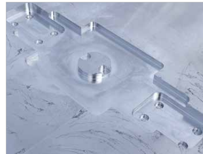
Funkcja „Opróżnianie kształtów swobodnych” w pełni automatycznie oblicza tory frezowania, potrzebne do zrównania całej powierzchni danego kształtu swobodnego. Podczas opróżniania można pominąć wcześniej zdefiniowane „wyspy”.
