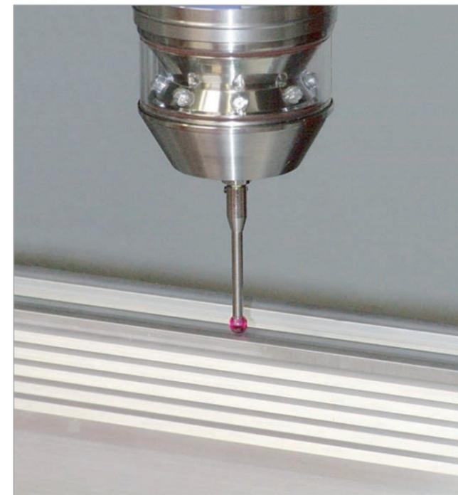
Medir con pulsador 3D. Así pueden posicionarse exactamente las mecanizaciones incluso con tolerancias de perfil.
