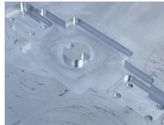
La función "Evacuar forma libre" calcula automáticamente las pistas de fresado necesarias para la remoción de material de toda la superficie de la forma libre indicada. Al extraer es posible evitar las "islas" definidas previamente.
