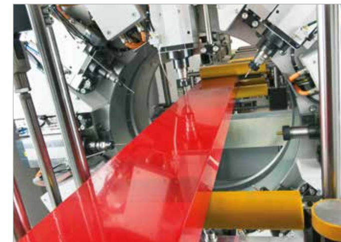
Innovatives Rotationsmodul, bestückt mit acht Spindeln
