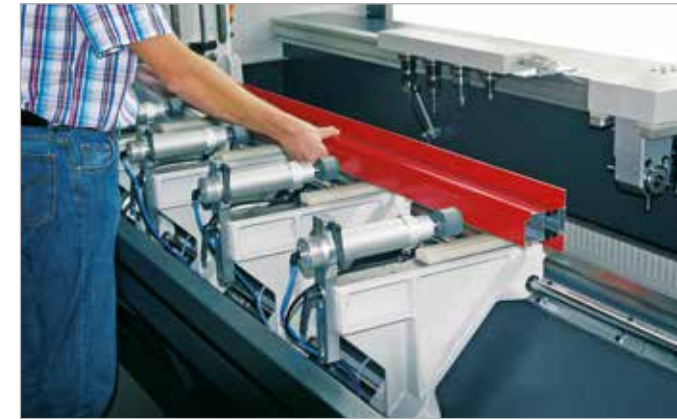
Maschinenbett, das als modernes „Schrägbett“ ausgeführt ist
