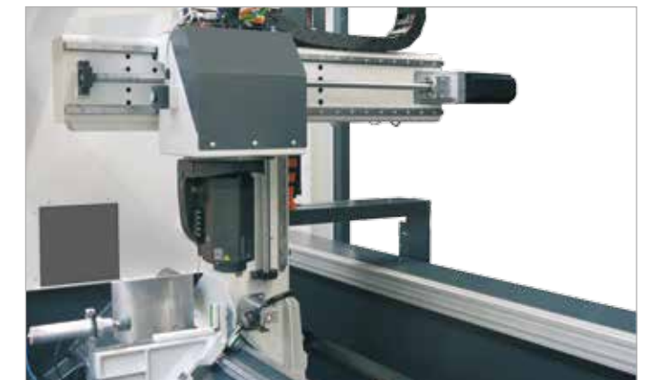
Stufenlose Winkelverstellung von -120° bis +120° (A-Achse)
