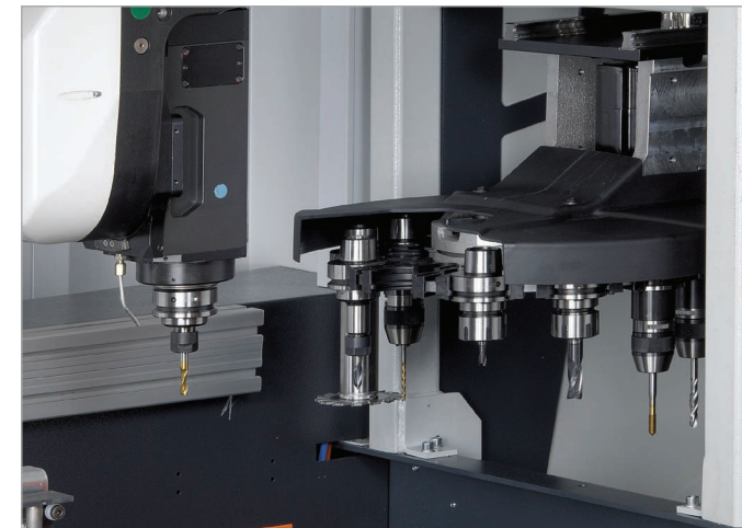
Magazynek obrotowy z 12-krotnym zmieniaczem narzędzi
