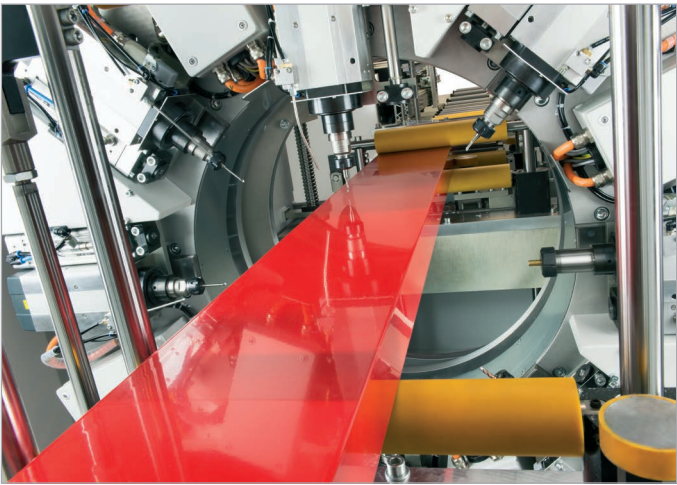
Module rotatif innovant doté de huit broches
