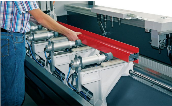
Bâti de la machine sous forme de "banc incliné" moderne
