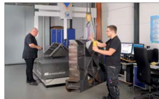
V merilnem prostoru natančno preverijo vse sestavne dele iz lastne proizvodnje.
