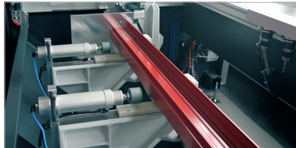
Die neuen, schmalen Spanner vergrößern die Bearbeitungsräume und verfügen über eine extrem hohe Steifigkeit.
