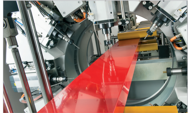
Innovatives Rotationsmodul, bestückt mit acht Spindeln
