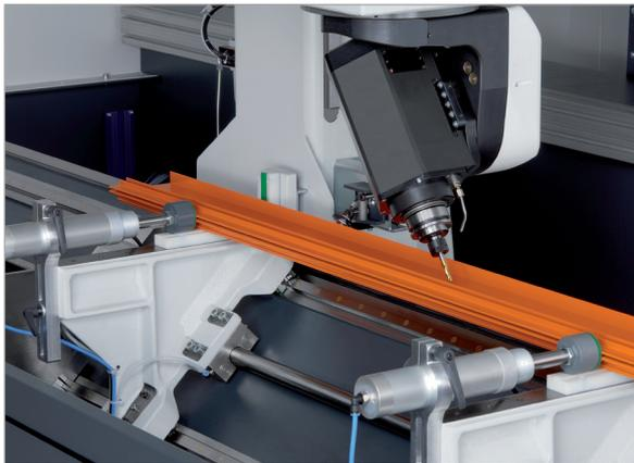
Tête d'usinage à axes A et C
