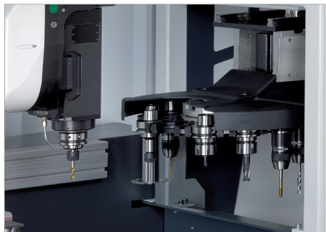
Drehmagazin mit 12-fach-Werkzeugwechsler
