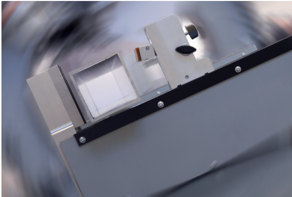
Die motorisierten Spanner öffnen in beide Richtungen. So sind auch empfindliche Profilloberflächen bestmöglich vor Kratzern geschützt.
