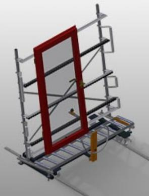
Вертикальный рольганг для транспортировки оконных элементов
