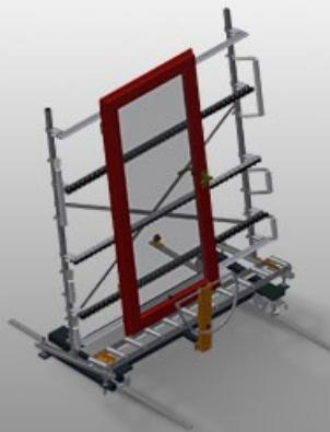
Вертикальный рольганг для транспортировки оконных элементов
