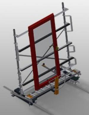
Вертикальный рольганг для транспортировки оконных элементов
