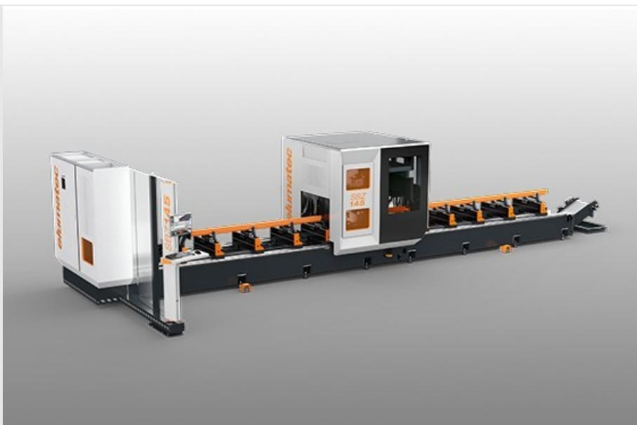
SBZ 145 с 5 осями обработки разработан с учетом требований металлообрабатывающей отрасли и промышленного применения и имеет зону обработки 560 мм x 350 мм x 7500 мм. Станок оснащен автономной осью прижимов и вместительным магазином для фрез, сверл, метчиков и пильных дисков. SBZ 145 подходит для самых разных вариантов обработки: от обработки и распила профильной заготовки до обработки предварительно распиленных одиночных деталей в опциональном челночном режиме (2x 3250 мм).
