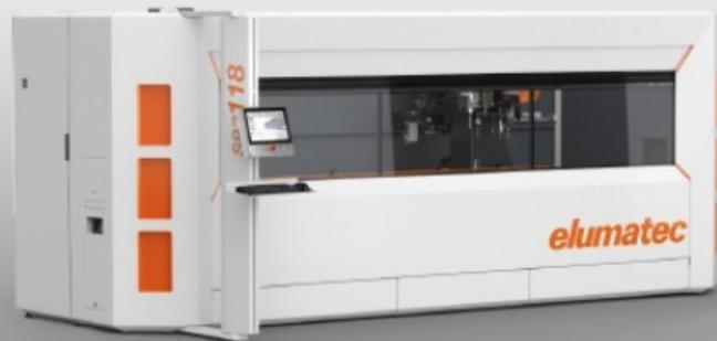
**SBZ 118, 3-осевой профильный обрабатывающий центр с опциональной 5-сторонней обработкой, простой в использовании и имеющий минимальную площадь, расширяет Ассортимент продукции начального уровня компании elumatec для автоматизированной обработки с ЧПУ алюминиевых, ПВХ и тонкостенных стальных профилей. Благодаря своей обработке Длина обработки составляет три метра, эта универсальная и мощная модель является самым компактным станком с ЧПУ в текущем ассортименте elumatec.**
