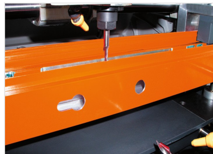
Двухшпindelный копировально- фрезерный станок KF 78/23
