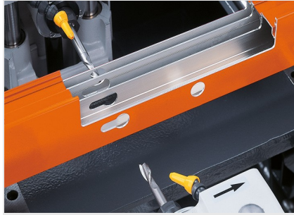
Трехшпindelный копировально- фрезерный станок KF 178/10
