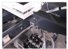
**Шуруповерт**Подвижный шуруповертный модуль с пневматической регулировкой высоты
