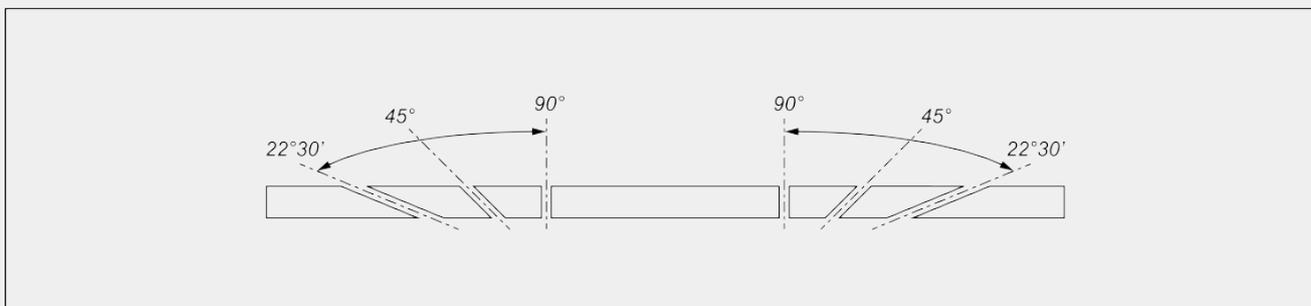
Механическая регулировка промежуточных углов
