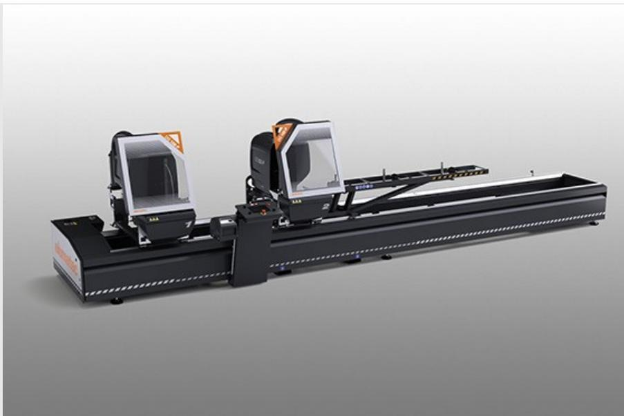
Электронный двухголовочный отрезной станок с автоматическим перемещением подвижной головки с помощью бесщеточного двигателя, управляемого числовым программным управлением. Пневматический наклон режущих блоков с 90° до 22°30' (внеш.) в два фиксированных положения или в промежуточные угловые положения при помощи дополнительной механической системы регулировки. Гидравлическая подача режущего диска.
