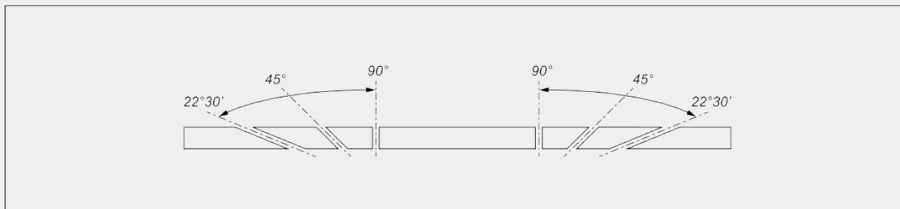
Механическая регулировка промежуточных углов
