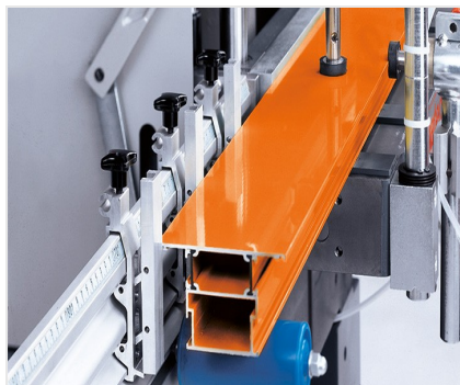
Одношпиндельный копировально- фрезерный станок AS 170/10
