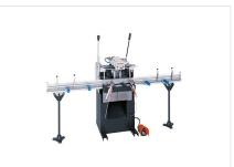
Одношпиндельный копировальнофрезерный станок AS 170/10
