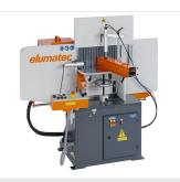
Фрезерный станок для фрезерования торцов AF 223/01
