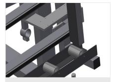
**Barras de pressão**Centragem pneumática. Precisão por aperto paralelo das barras em fixadores
