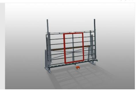
Unidade de controlo e colocação dos vidros para colocar vidros e realizar o controlo final
