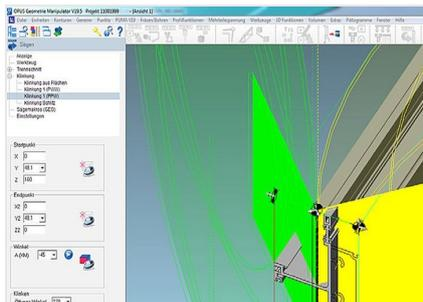
**Visualização da superfície de corte com serra no sistema Puma V19.**
