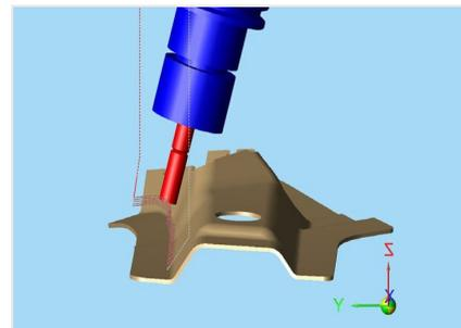
**Fresagem de rolos com 5 eixos simultâneos a partir da opção Modulworks**
