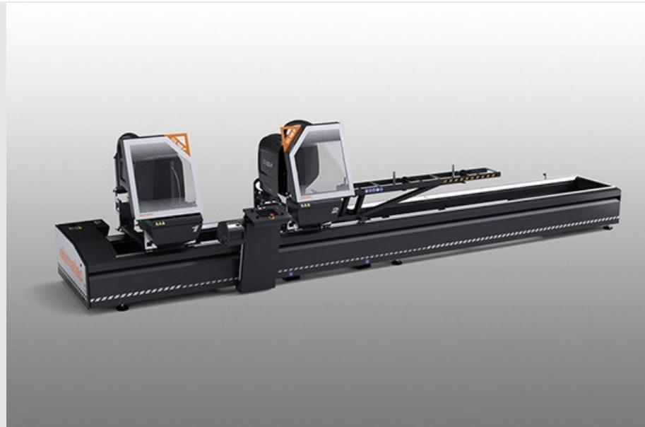
Máquina de corte com cabeça dupla eletrónica e com movimento automático da cabeça móvel através de motor brushless comandado por controlo numérico. Inclinação pneumática das unidades de corte de 90° até 22°30' (externa) em duas posições fixas ou com sistema opcional mecânico de regulação dos ângulos intermediários. Avanço óleo-pneumático do disco de corte.
