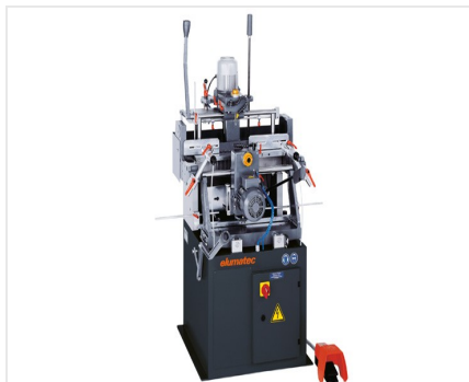
Dwuwrzecionowa frezarko-kopiarka KF 78/23
