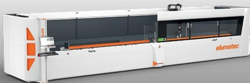
SBZ 125/85 è un centro di lavoro a 5 assi realizzato per lavorare profili in alluminio, PVC e acciaio a parete sottile. La lunghezza di 8 metri permette di lavorare sia in modalità pendolare sia in tutta la lunghezza.
