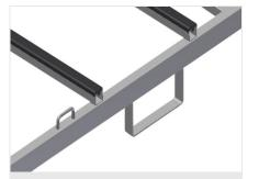
Staffa del carrello elevatore e supporto della cinghia di fissaggio
