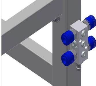
**Attacco dell'aria compressa quadruplo**
