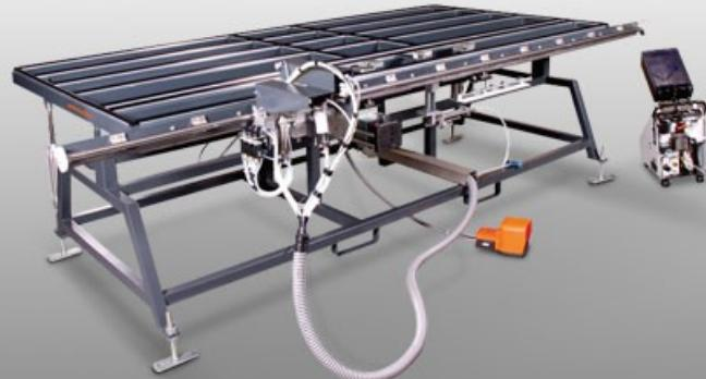
Centro di assemblaggio ante per il montaggio delle ferramenta su ante di finestre in PVC
