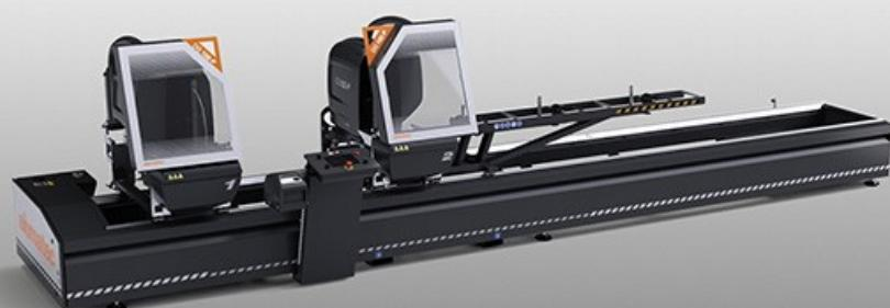
Troncatrice doppiatesta elettronica con movimento automatico della testa mobile tramite motore brushless comandato da un controllo numerico. Inclinazione pneumatica delle unità di taglio da 90° fino a 22°30' (esterna) in due posizioni fisse oppure con sistema opzionale meccanico di regolazione delle angolazioni intermedie. Avanzamento lama oleo-pneumatico.
