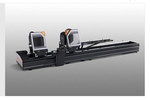
Troncatrice doppiatesta elettronica con movimento automatico della testa mobile tramite motore brushless comandato da un controllo numerico. Inclinazione pneumatica delle unità di taglio da 90° fino a 22°30′ (esterna) in due posizioni fisse oppure con sistema opzionale meccanico di regolazione delle angolazioni intermedie. Avanzamento lama oleopneumatico.
