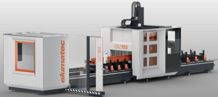
能够满足最高要求的5轴型材加工中心，首次采用龙门式设计构造：作为elumatec全新的顶级产品，SBZ 155型材加工中心将无以伦比的性能参数与开创性的设计合二为一。紧凑、灵活、快速：SBZ 155是铝合金、薄壁钢型材全自动CNC加工中心的里程碑、特别是其6面加工功能以及节省空间的可选配龙门驱动器。由于SBZ 155缩短了刀具换装时间，因此能够保证理想的加工循环，并且该款机床还具备极高的灵活性，因此金属加工以及工业领域的用户将会从中受益。大尺寸随动刀库可装备14个标准型刀具。依据不同的配置，还可配备最多六个特殊刀具以及两个直径为200或550 mm的锯片。龙门式设计和2个加工区域能够容纳和通过横截面最大高达1,000 x 380 mm的型材以及在穿梭式加工中的灵活作业。依据elumatec客户的单独要求，SBZ 155还可增加为数众多的选配项目。从双侧自动长度测量到二维码扫描，不会让您的任何愿望落空。此外，这一全能型设备也同样可以使用eluCloud，因此符合工业4.0的要求。
