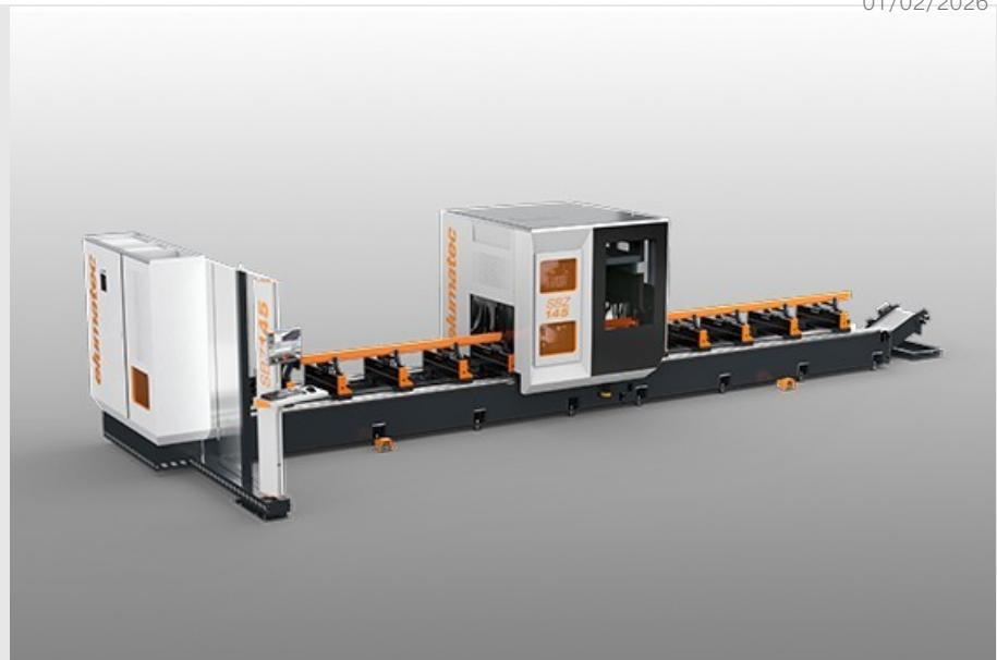
SBZ 145 专为满足金属结构和工业用途的要求而设计、配备 5 个加工轴、加工范围为 560 mm x 350 mm x 7500 mm。配备了一个自主夹紧轴和一个大尺寸刀库、可存放铣刀、钻头、丝锥和锯片。SBZ 145 具有多种加工选项、可从型材棒进行加工和切割、或者可以选择穿梭式加工 (2x 3,250 mm) 处理预切割的单个零件。
