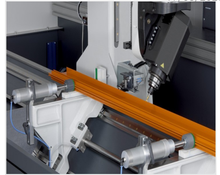
SBZ 122/74 型材加工中心
