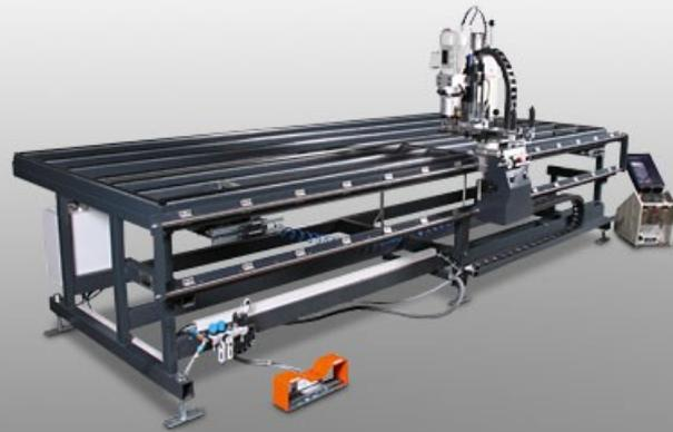
创新型、高效的五金件钻孔及上螺钉工作站、适用于角型铰链式框架。加工特别迅速、精准、该机器可极大提高生产窗子时的效率。通过简便的操作和符合人体工程学的加工流程、一名员工即可完成向角型铰链上钻孔、放置并拧紧螺钉的操作。由于可移动止挡系统的存在、省去了通过模板来钻支撑孔和螺钉孔这种高花费的做法。在加工含有多个窗扇的框架时、该单元可以转动
