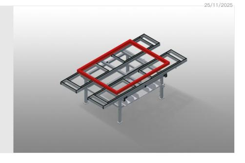
用于在框架和窗扇上进行加工作业的可抽拉组装工作台
