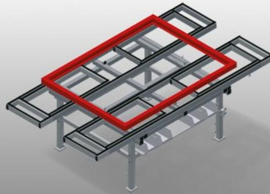
用于在框架和窗扇上进行加工作业的可抽拉组装工作台。钢制结构、坚固稳定。通用型组装工作台。可向四个方向拉出。非常适用于大型的门窗组装。高度可调。带塑料滑条的工作台支承面。在工作台面下设计有实用的存放架。四个用于小配件、五金件和螺栓的塑料箱。四路压缩空气接口。模块化结构、组装简便。
