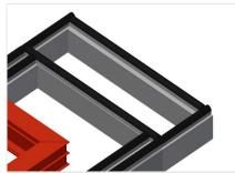
**橡胶条** 工作台支承面橡胶滑条
