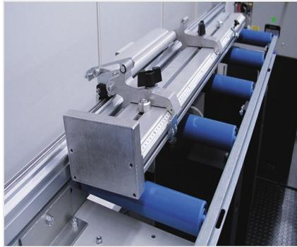
长度定位和测量系统 MMS 200
