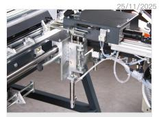
带批头和手动送料斗的螺丝刀 带批头和手动送料斗的螺丝刀,用于第二种螺长度的
