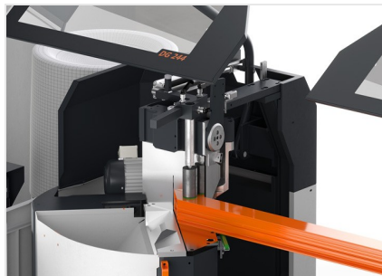
双头斜榫切割机DG 104 小尺寸夹头
