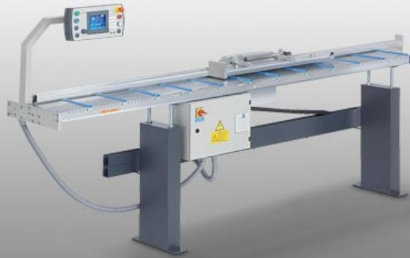
配备自动切割长度调节和E 355定位控制系统的长度定位和测量系统
