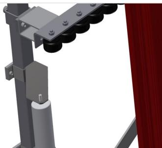
**Регулировка высоты роликового полотна**
