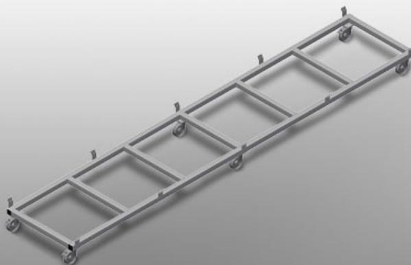
Прочная стальная конструкция. Транспортная тележка для перемещения кассет с профилями. Идеальное решение для транспортировки кассет с профилями со склада к пильному станку или на обрабатывающий центр. Для поддонов с профилями шириной до 760 мм. Стопорные планки для фиксации поддона. Шесть роликов, четыре направляющих ролика со стояночным тормозом и два опорных ролика.
